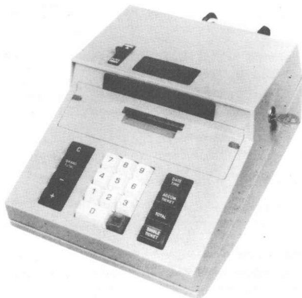
Afb.7.Het Frama "Loket-biljet-afgifteapparaat", of kortweg: de Loketmachine. De stroken komen - na de juiste aanslag op het toetsenbord - uit de gleuf die zich daar vlak boven bevindt.
