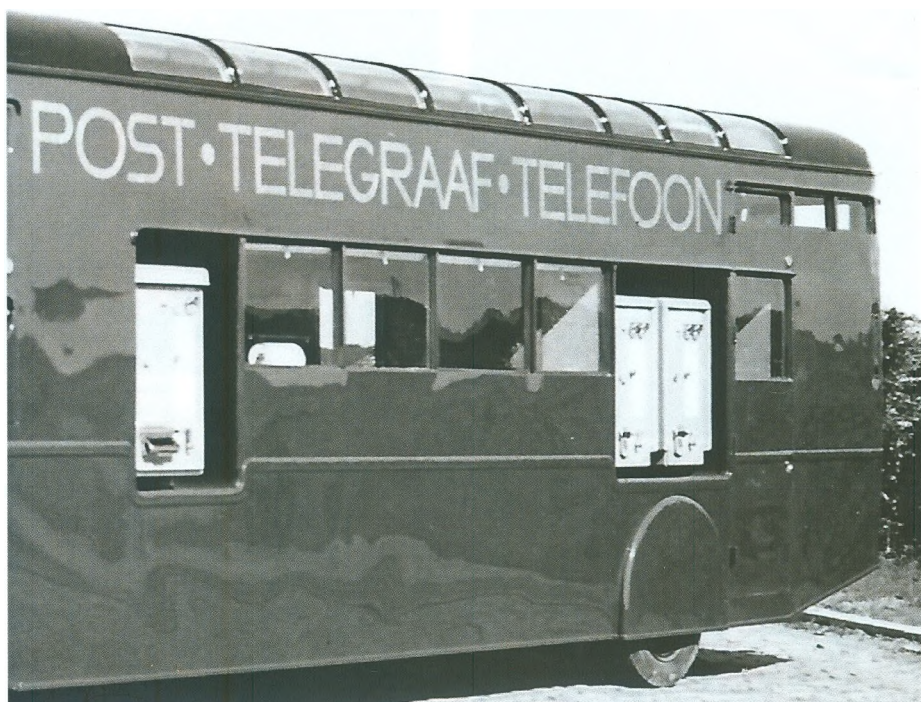
Afb. 1. Aan deze zijde van de oplegger zitten (rechts, achteraan) twee postzegelautomaten en in het midden een automaat voor de afgifte van briefkaarten.
