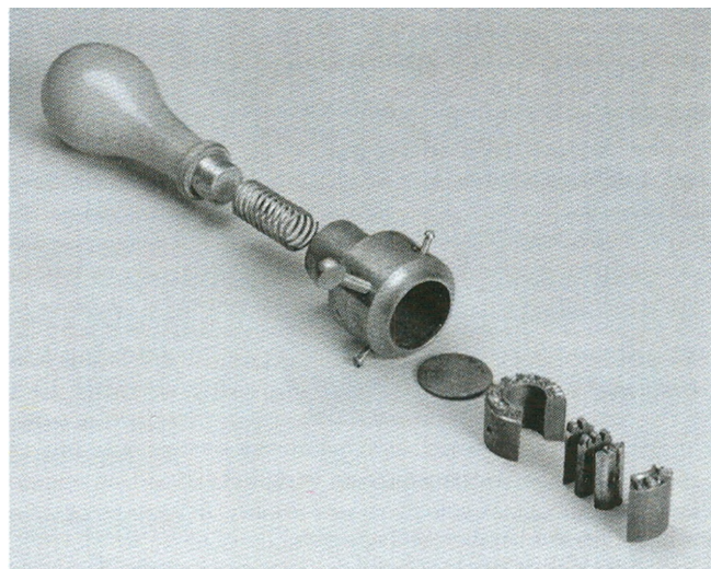
Afbeelding 1: de onderdelen van een dagtekeningstempel. Van links naar rechts: houten heft, veer, bus, uitdrukplaatje, naamring, drie datumkarakters en een uurkarakter.
