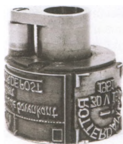
Afbeelding 1. Stempelkop van een stempelmachine, met 'stok' (stempelgedeelte met plaatsnaam en datum) en 'vlag' (4 cm vrijlaten voor de post). De karakters voor de datum kunnen elk afzonderlijk verwisseld worden.
