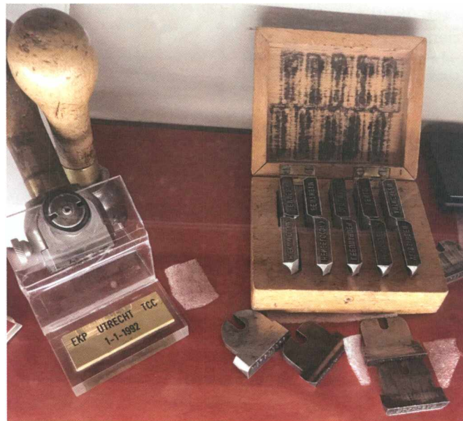
Afbeelding 7 Het blokstempel in onderdelen. Duidelijk te zien zijn de losse delen met de stationsnamen
