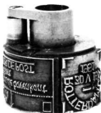
Afb.9: Foto van een stempelkop in de stand waarin die in de machine geplaatst is, dus op z'n kop. (In spiegelschrift: Rotterdam CS. /30V16/ 1951 en 4cm / langs de bovenkant / vrijlaten / VOOR DE POST). Op deze foto is duidelijk te zien dat vlag en datumstempel twee aparte elementen zijn, die afzonderlijk uitgenomen kunnen worden. (Foto PTT)
